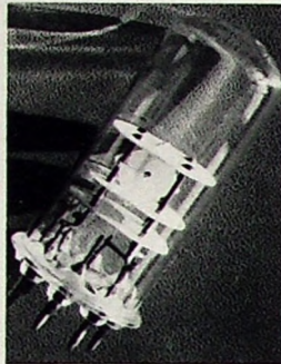
Bild 27. Schwingquarz im evakuierten Röhrenglaskolben; der Quarz vibrator ist ein Flächenschwingschwing mit CT-Schnitt für 304 kHz (SEL)
