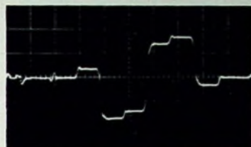
Bild 2. (R — Y)-Signal am Wehneltzylinder (für Farbbalken)
