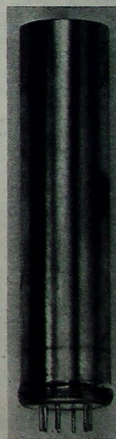
Bild 23. Schwingquarz im evakuierten Röhrglas Kolben mit 7poligem Miniatursockel (Steckquarz) [7]: a) Ansicht, b) Maßskizze und Anschlußschemata des Röhrensockels für verschiedene Elektrodenanordnungen des Quarzes
