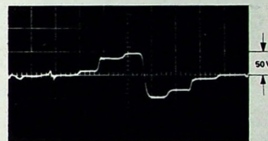
Bild 3. (G — Y)-Signal am Wehneltzylinder (für Farbbalken)
