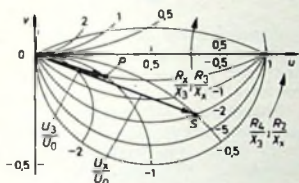
Bild 9. Zeigerdiagramm für U_3/U_0 und U_x/U_0
