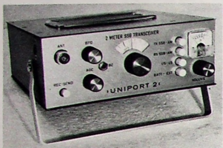
Bild 4. Außenansicht des 2-m-SSB-Transceivers „Uniport 2“ (Glonner)
